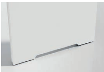
Ventilační podfrézování / Ventilačné podfrézovanie Podfrézování 15mm – pro místnosti s rekuperací / Podfrézovanie 15mm - pre miestnosti s rekuperáciou Podfrézování 26 mm – pro dveře 80'-100' / Podfrézovanie 26 mm – pre dvere 80'-100' Podfrézování 38 mm – pro dveře 60'-70' / Podfrézovanie 38 mm – pre dvere 60'-70'
